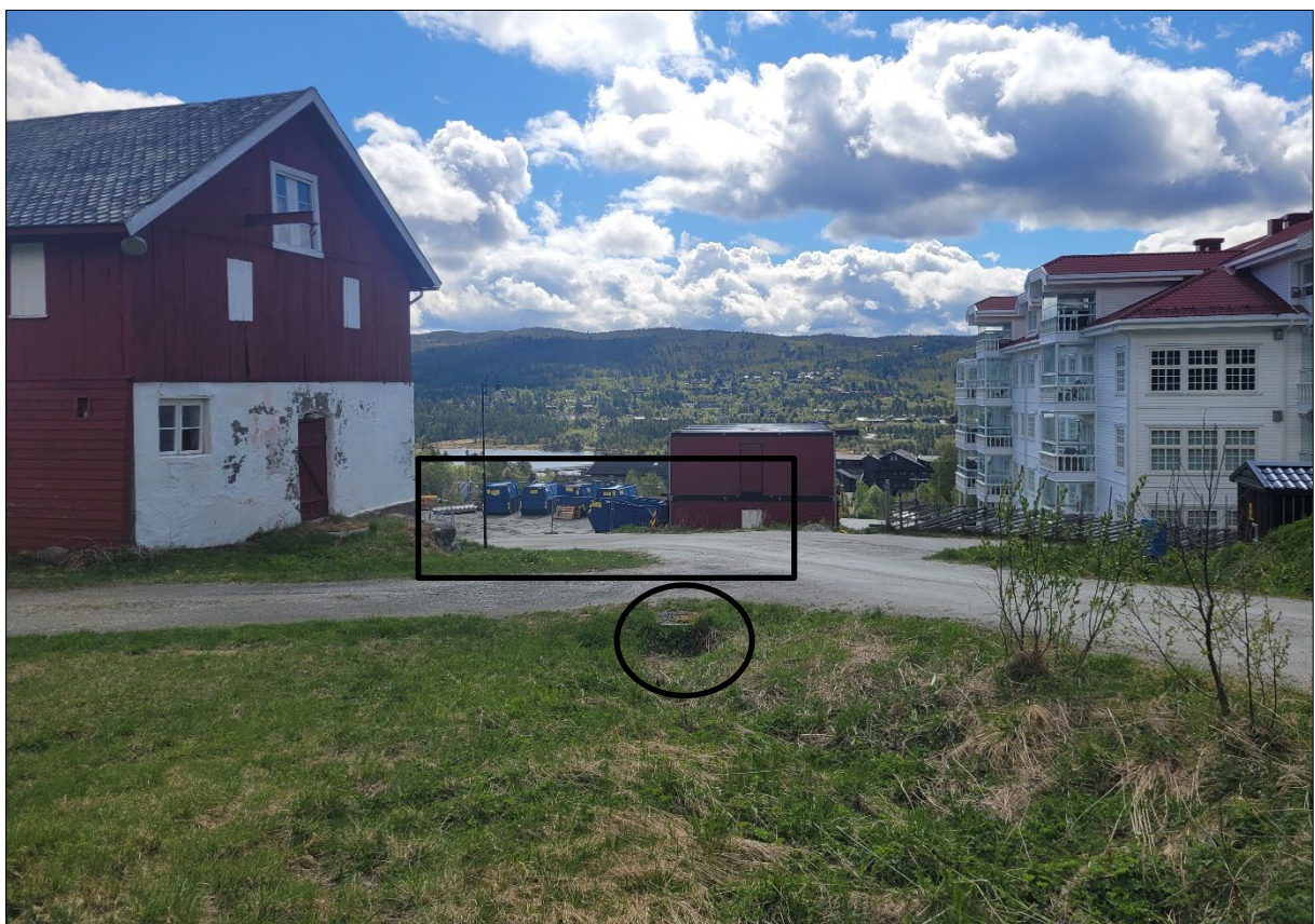
Figur 13: Biletet viser grøft langs Slaattavegen, og at vatnet vert ført i ein kum (sirkel) ovanfor kartleggingsområdet (rektangel). Biletet viser mot sør.
