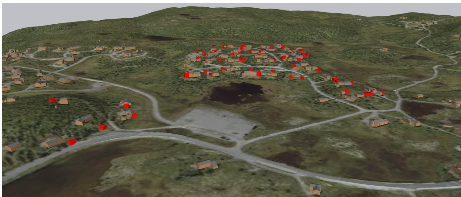
Figur 9. Illustrasjon over estimert maksimal økning i samla bygningsmasse ved foreslått planendring. Potensiell ny bygningsmasse med planendringen er farget rød og utnyttet utbyggingspotensial i gjeldene plan er farget grått. Modell uten vegetasjon.
