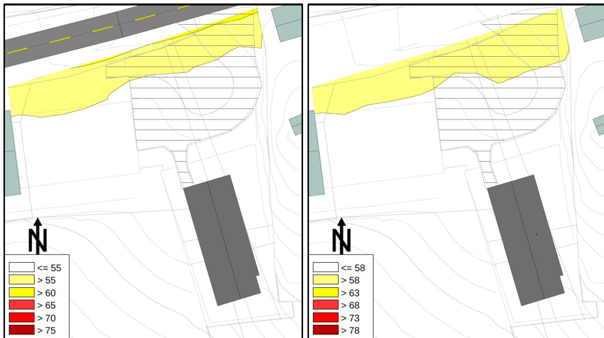
Figur 5-4. Beregnet støynivå på dagtid mellom 07 og 19, L_d [dB], på uteareal for veitrafikk (t.v.) og togtrafikk (t.h.) beregnet i 1,5 m høyde.
