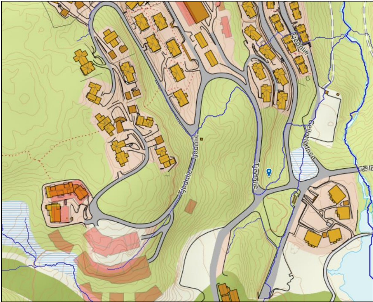
Figur 9: Dreneringslinjer for minimum 5000m 2 som går gjennom planområdet.
