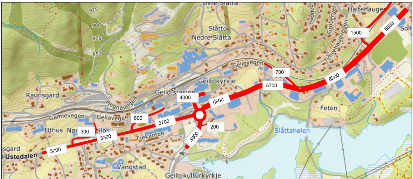
Figur 2-10 ÅDT for 2024 anslått langs rv.7 i de sentrale delene av Geilo beregnet med utgangspunkt i korttidstallene. Det er størst relativ usikkerhet for sidevegene til rv.7 og for de aller minste trafikktallene.
