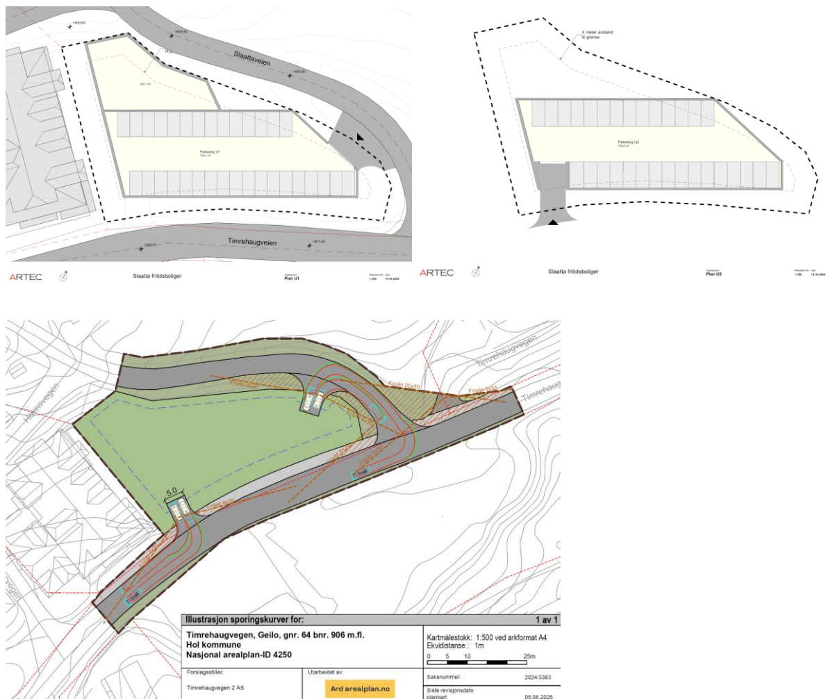
Figur 35: Sporingskurver for inn og utkjøring til garasjekjeller.
