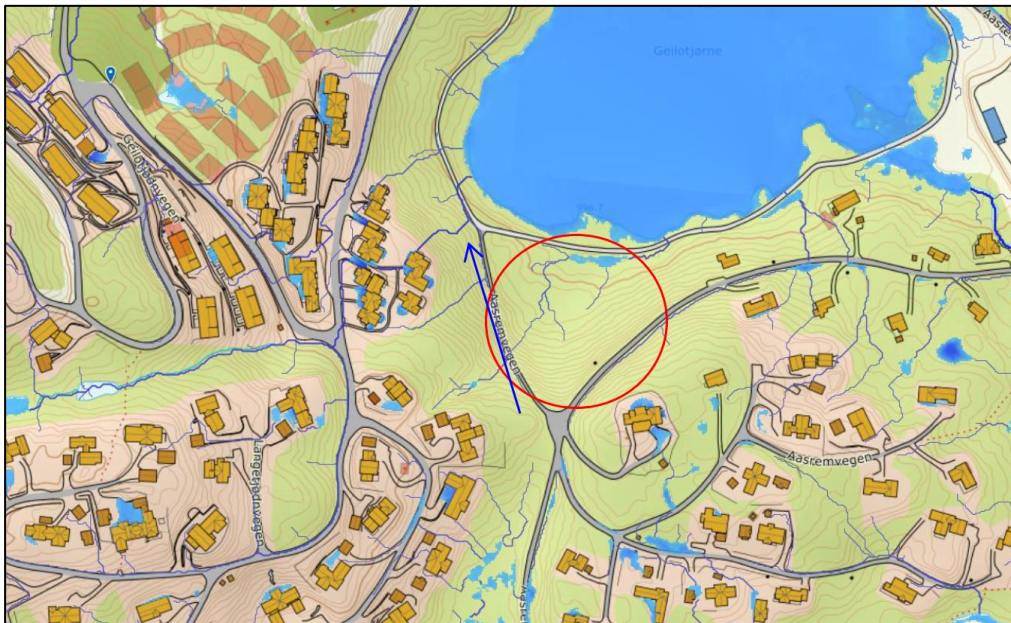
Figur 10: Dreneringslinjer og lavpunktsanalyse Scalgo Live.
