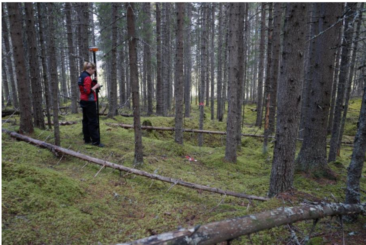
Figur 1: Innmåling av kulturminner ble gjort med en avansert GPS (C-pos).
