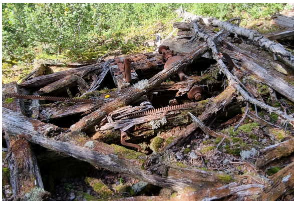
Bildet viser sagspindel med reimskive, stillapparat for innstilling av plankens tykkelse og sveiv for framdrift av sagbenken. Til høyre for sagspindelen stikker spaltekniiven opp. Foto: Erling Bjørkheim 2024.
