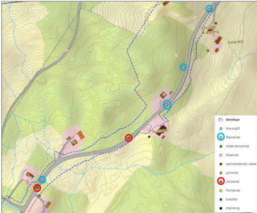
Figur 4-30 Jordskred vist med rød sirkel og steinskred vist med blå sirkel. Planavgrensningen vist med blå stiplede linje [11].
