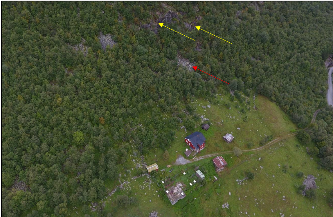
Figur 25: Nørdre Bry, med ovenforliggende fjellskrenter (gul pil), steinur (rød pil) og titalls steinblokker (grå prikker) i terrenget rundt bygningene, tidligere utfall fra skrentene.
